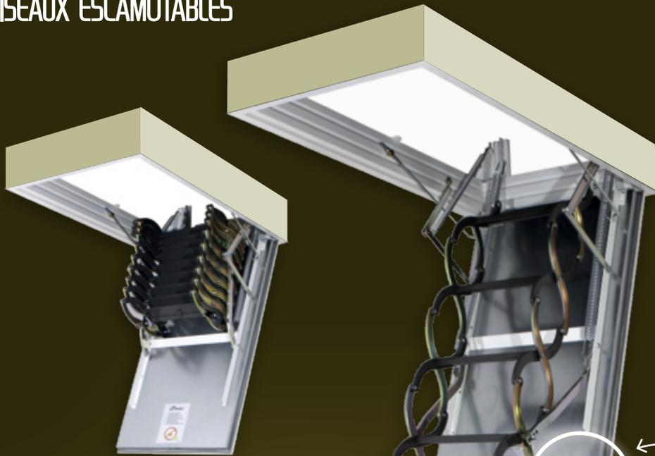
Le modèle LSF consiste en une échelle de grenier métallique à ciseaux coupe-feu d'accès facile bloquant les flammes en cas d'incendie. La trappe est constituée de matériaux à l'épreuve du feu et comprend un joint gonflant sous l'effet d'une chaleur extrême. L'échelle LSF a une durée de résistance au feu de 60 minutes (EI260) selon la norme européenne EN 13501-2.
