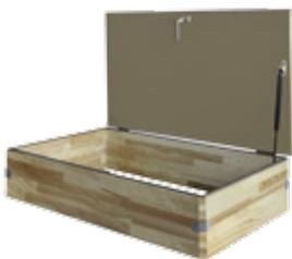
La trappe supérieure empêche l'accumulation de la poussière du grenier sur la trappe et les échelons de l'échelle fermée. Elle améliore les propriétés isolantes et l'étanchéité de l'échelle sur laquelle elle est installée. La hauteur du caisson de la trappe supérieure est de 20 cm (7¾ po). Disponible pour les échelles WN, LWP, LWT, LWF, OWM et LMS. Dans le cas de l'échelle LST, l'installation préalable de l'extension de caisson LXN est nécessaire.
