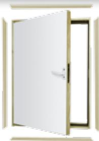
La trappe d'accès au vide sous toit s'installe sur les cloisons d'une structure mansardée donnant accès à l'espace non habitable derrière le mur sous le toit. La trappe isolée assure une excellente isolation thermique (valeur R de 5,2) et une étanchéité élevée minimisant ainsi les pertes et les gains de chaleur. La trappe d'accès au vide sous toit est offerte dans une version ouvrant à gauche ou à droite. Une moulure de finition est incluse avec la configuration standard.
