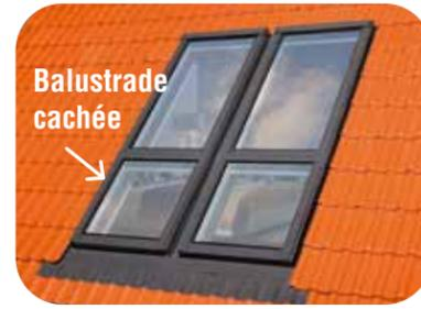
Le vantail supérieur peut être soulevé en douceur jusqu'à un angle de 45°. Les garde-corps latéraux de sécurité sont intégrés dans le vantail inférieur et basculent vers l'avant lors de l'ouverture du vantail.
