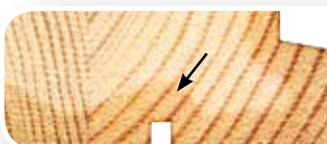
Utilisé dans les fenêtres de toit FAKRO, l'imprégnation sous vide et le revêtement durable protège les éléments en bois de la fenêtre. L'imprégnation sous vide est plusieurs fois plus efficace que l'imprégnation par immersion.
